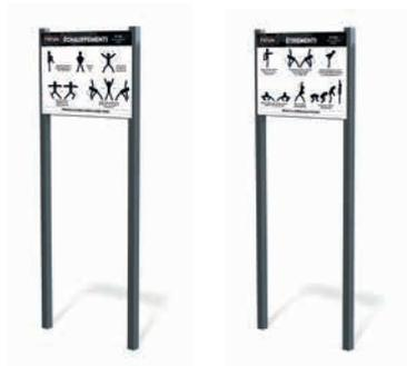
Panneau en Dibond (stratifié pris en sandwich par deux plaques d'aluminium) 700 x 500 x 2 mm, fond vinyle blanc, impression numérique thermique en quadrichromie, laminage (film protection anti-UV) fixé sur un cadre en acier (tube 50x50 mm) traité et peint.
