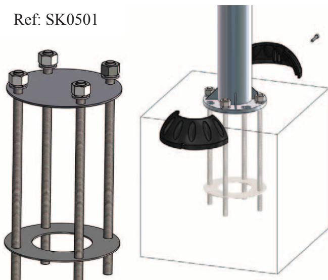
5) Après séchage du béton, positionner la platine de l'appareil selon l'orientation souhaitée dans les 4 tiges filetées, mettre les rondelles plates, et visser fortement les écrous à l'aide d'une clé de 30 mm.
