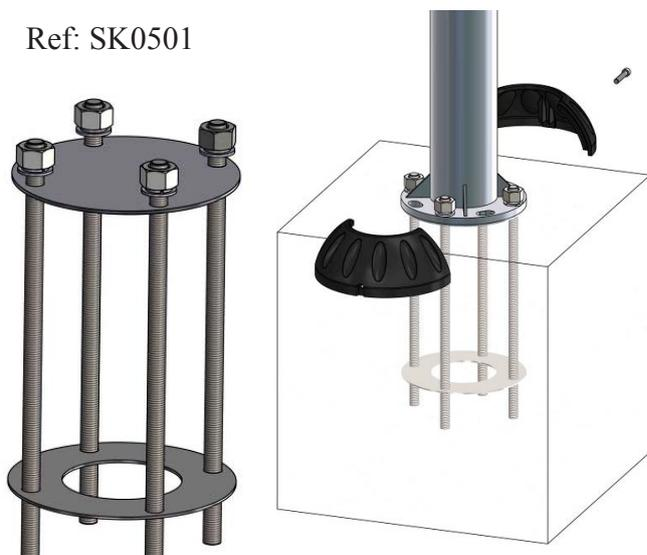
5) Couler le béton dans les trous de 30x30 au même niveau que celui de 60x60x60cm, les remplir à ras.
