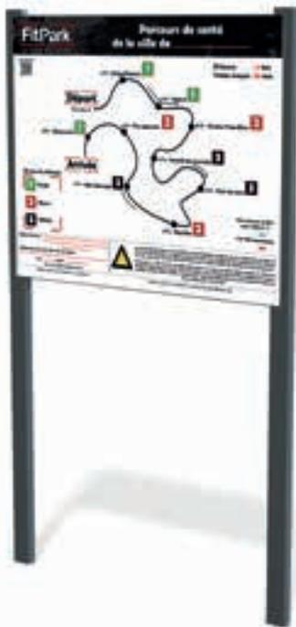
Panneau d'affichage en Dibond (stratifié pris en sandwich par deux plaques d'aluminium) 1200 x 1000 x 2 mm, fond vinyle blanc, impression numérique thermique en quadrichromie, laminage (film protection anti-UV) fixé sur un cadre en acier (tube 80x40 mm) traité et peint.
