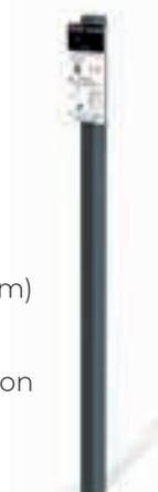
Panneau en Dibond (stratifié pris en sandwich par deux plaques d'aluminium) 125 x 250 x 6 mm, fond vinyle blanc, impression numérique thermique en quadrichromie, laminage (film protection anti-UV) fixé sur un poteau en acier (tube 50x50 mm) traité et peint.
