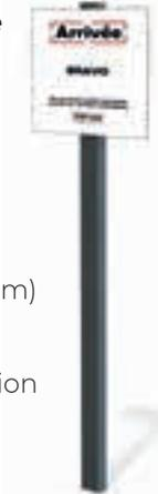
Panneau en Dibond (stratifié pris en sandwich par deux plaques d'aluminium) 400 x 500 x 6 mm, fond vinyle blanc, impression numérique thermique en quadrichromie, laminage (film protection anti-UV) fixé sur un poteau en acier (tube 80x40 mm) traité et peint.
